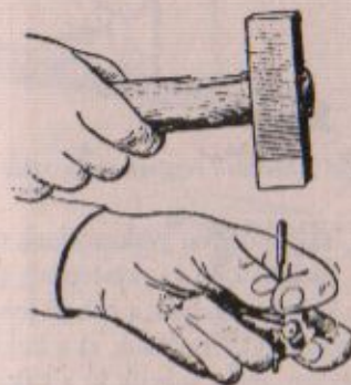
15. ábra: Az ütőszegcsap kiütése
