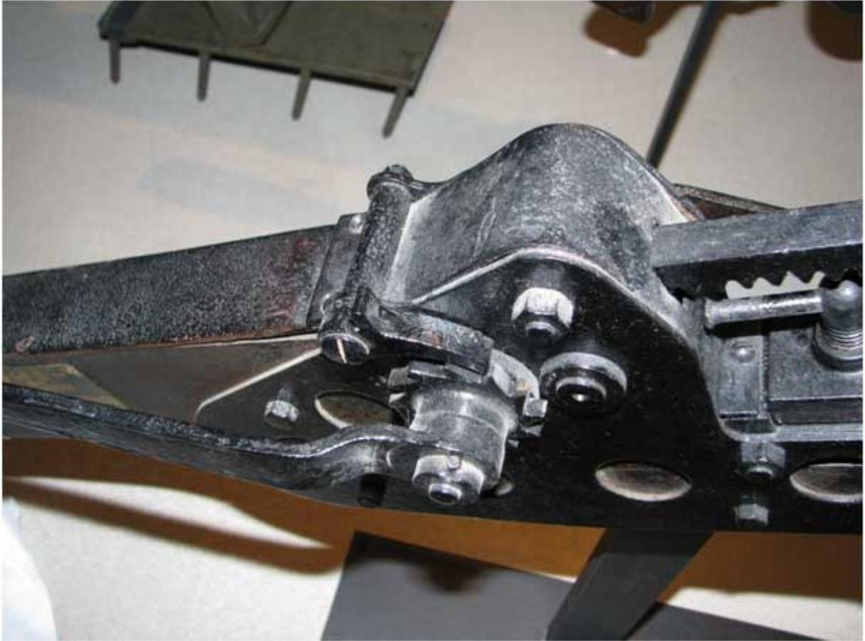
Figure 27 Système d'armement à crémaillère avec double manivelle et cliquet anti retour (Photo au musée des Invalides © JM Kalouguine)
