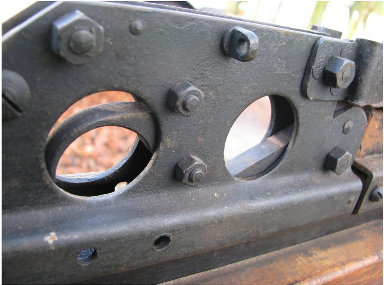
Figure 30 Queue de détente dans le déclic (photo au musée des Invalides ©JM Kalouguine)
