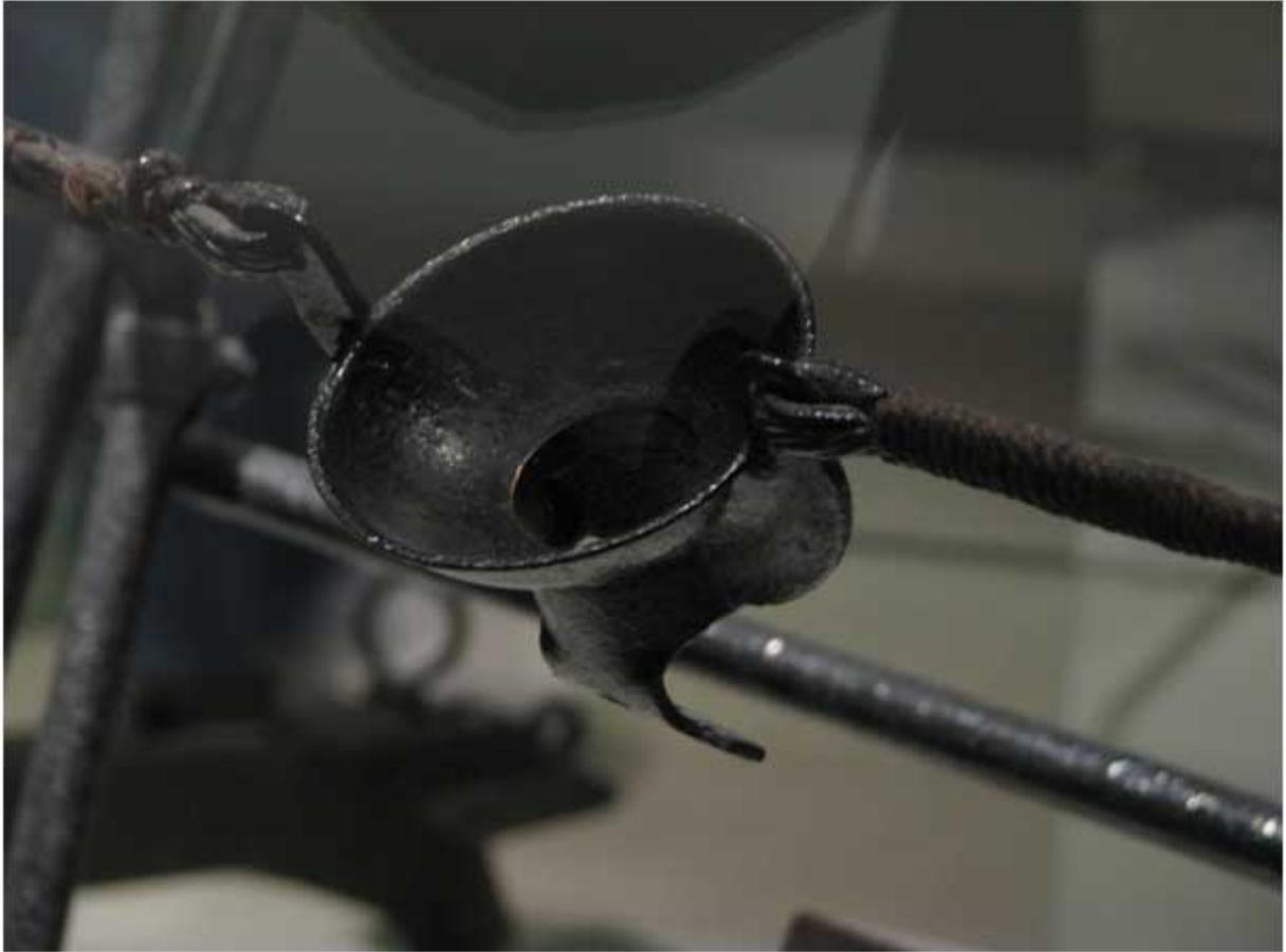
Figure 25 Fronde pour grenades d'artillerie de la sauterelle type A (Photo au Musée des Invalides ©JM Kalouguine)
