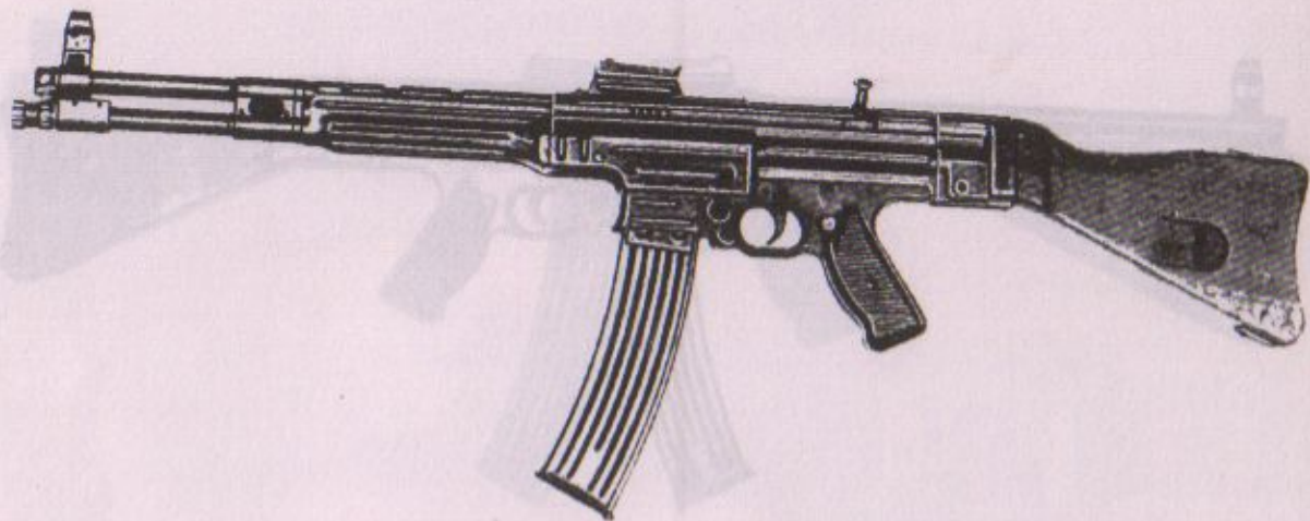
Obrázek 10 M.K.b. 42 (H) se závěrem v zajištěné poloze. Natahovací páka je zaklesnuta za vybrání pouzdra závěru.
