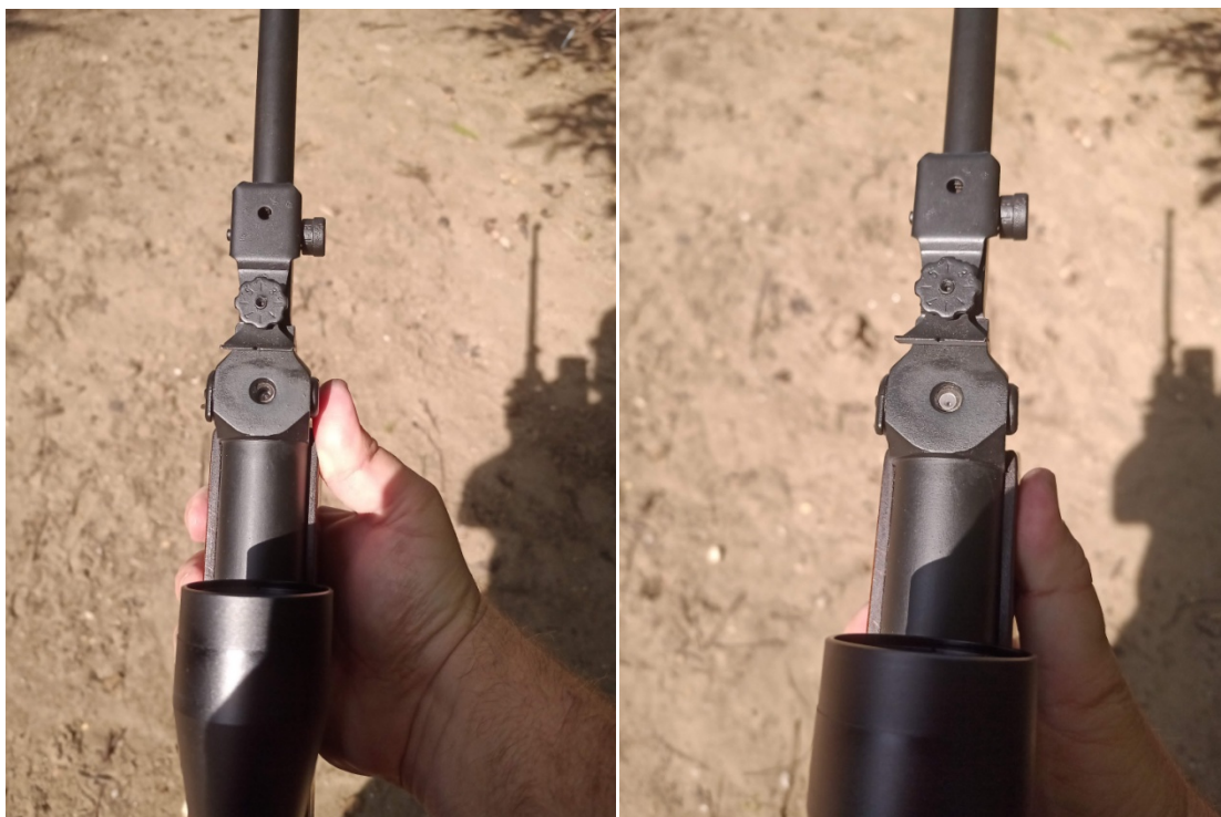
20. ábra Reload és leader lövedékek a lövedékkamrában, látható, hogy a Reload sokkal mélyebben ül
