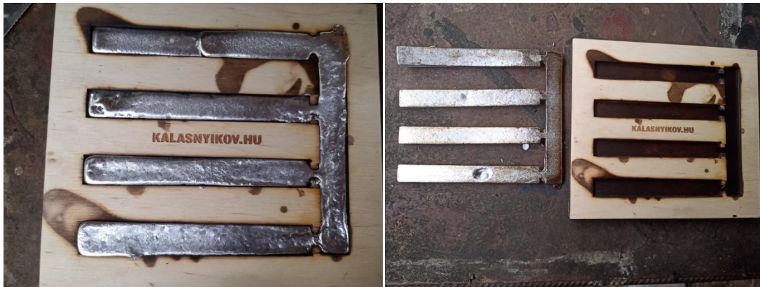
14. ábra Az ólomöntés sablonba, öntött előgyártmányok a sablon mellett
