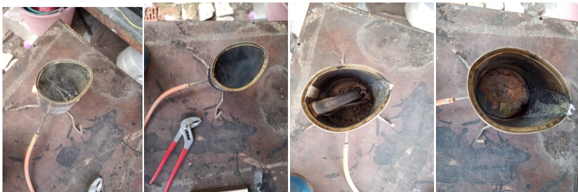
13. ábra Az ólomöntés folyamata a konzervdoboz kokillából
