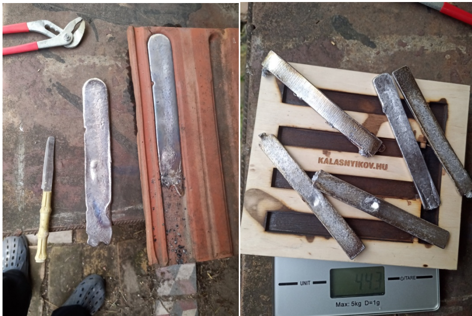
15. ábra Tetőcserépre is önthetünk, de a saját öntőforma szebb előgyártmányt eredményez
