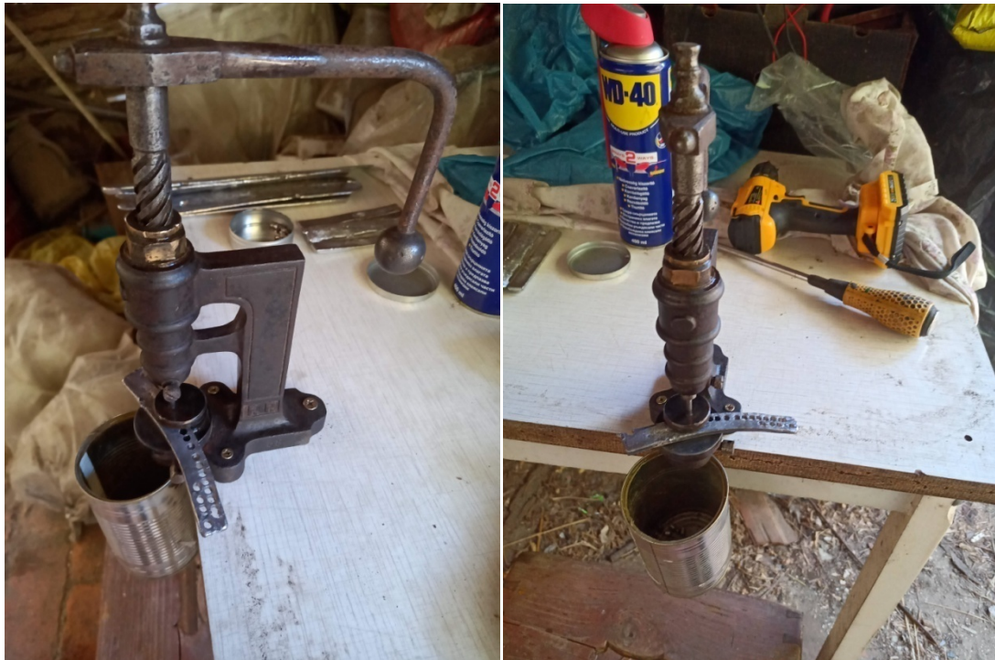
16. ábra Lövedékprézelés (mélyhúzás)
