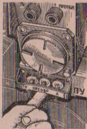
2. ábra. Az „Áramátalakító” (ПРЕОБ) kapcsoló bekapcsolása a T-54B és T-55, T-55A harckocsinál
