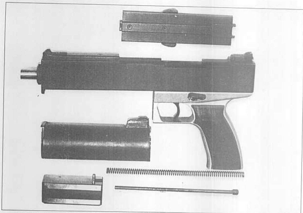
A VD.01. részlegesen szétszerelve. Alkatrészek (fentről lefelé): tokfedél, tok a csővel és a markolattal, hengertár, belyretolórugó, belyretolórugó vezető, zár
