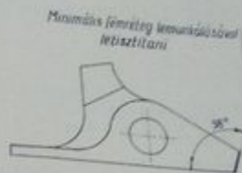
5. ábra. A tárrögzítő-retesz felső végének lemunkálása
