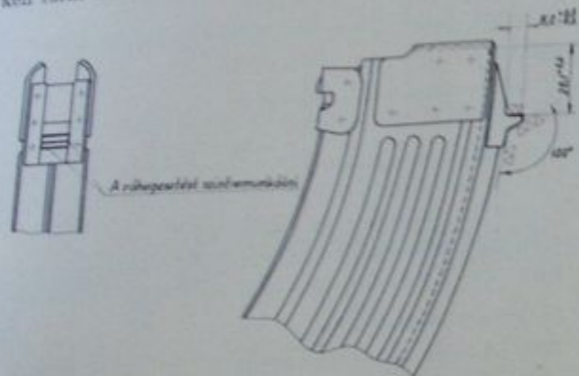
17. ábra. A tártámasz megmunkálással ömlesztőhegesztés után
