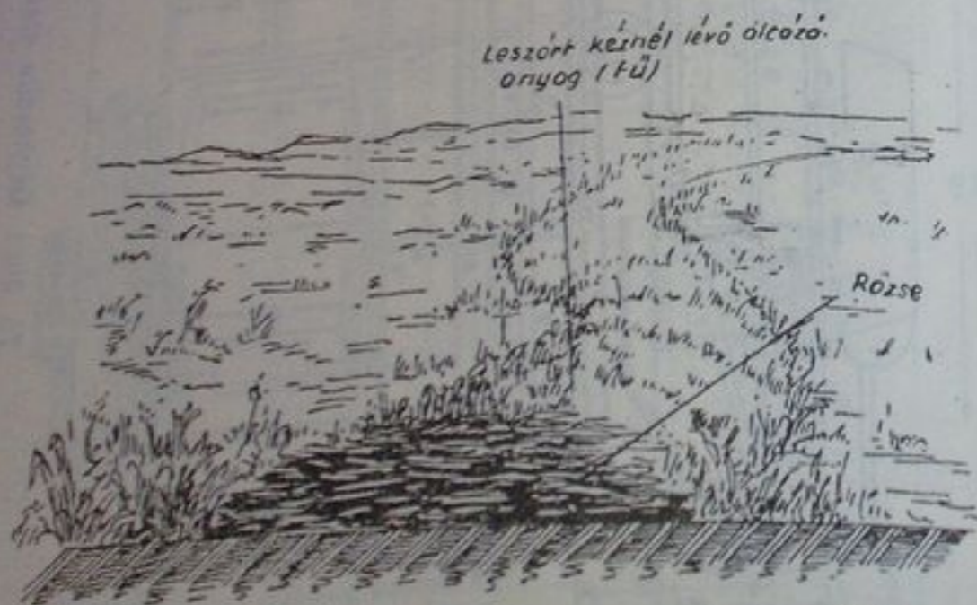
77. ábra. Színlelt lövészárók vesszőből és fűből. Elkészítés ideje: 10 fm. 0.8 munkásóra. — Anyag: rőze 0.4 kocsi.
