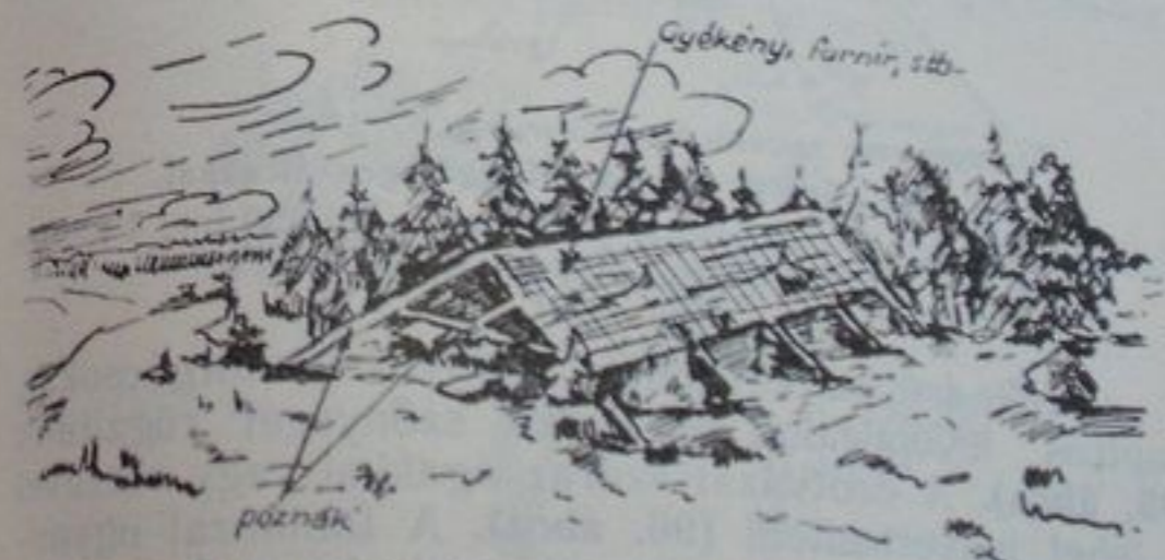
93. ábra. Nyeregtetős ház utánzata bokrokkal benőtt területen. Elkészítés ideje: 10 munkásóra. — Anyag: pózna 50 fa, gyékény 70 m 2 , drót 3 kg., szög 0.5 kg.
