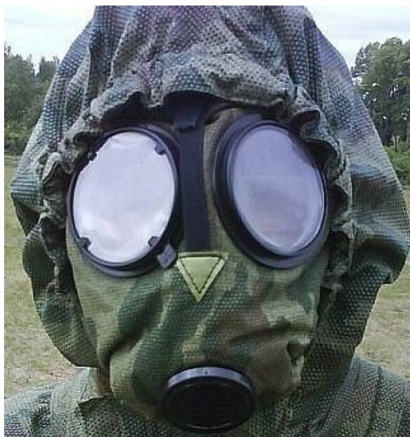
30. számú kép Orosz ROU típusú, szűrőanyagból készült gázálarc 30
